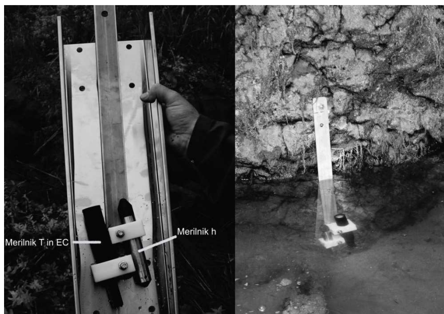
Slika 3. Levo: Merilnik temperature in električne prevodnosti ter merilnik nivojev; desno: nameščen merilnik na terenu (Foto: Blaž Kogovšek)
