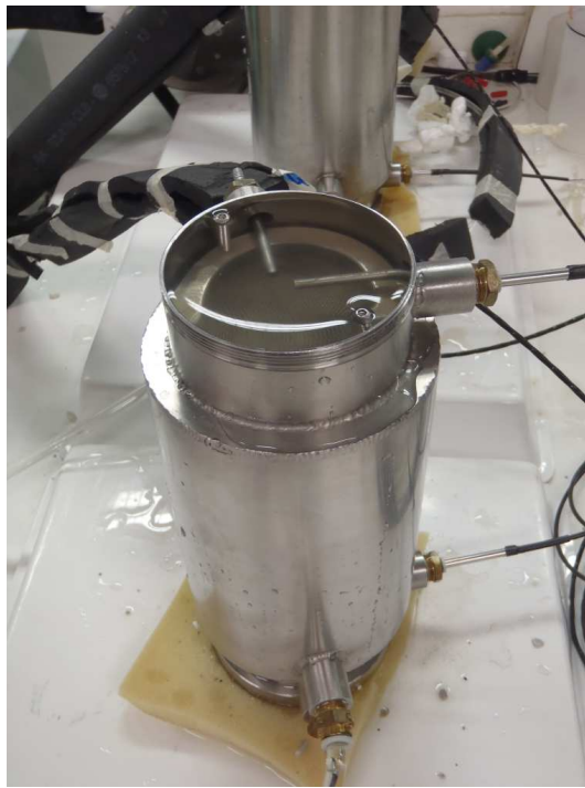
Slika 3 Pretočni inkubator za sedimente, kjer je mogoče meriti respiracijo (porabo kisika) v različnih sedimentih ob kontroliranih pogojih pretoka in temperature.
