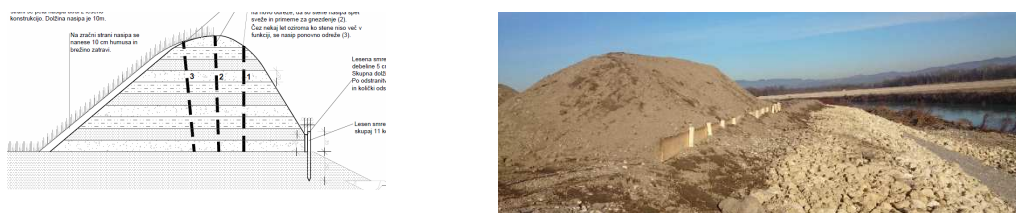
Slika 5 Gnezdilna stena za vodorce: levo projektna rešitev, desno med gradnjo
