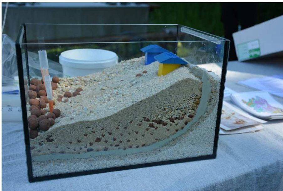
Slika 2: Primer modela vodonosnika v prenosnem akvariju
